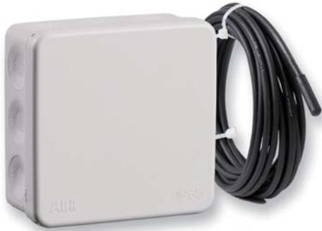
Система защиты трубопровода должна контролироваться выключателем. Используйте терморегулятор для включения системы защиты от замерзания только при необходимости, сокращая тем самым ненужное энергопотребление. Без терморегулятора срок службы саморегулирующегося кабеля значительно сокращается так же, как если бы саморегулирующийся кабель непрерывно работал.
